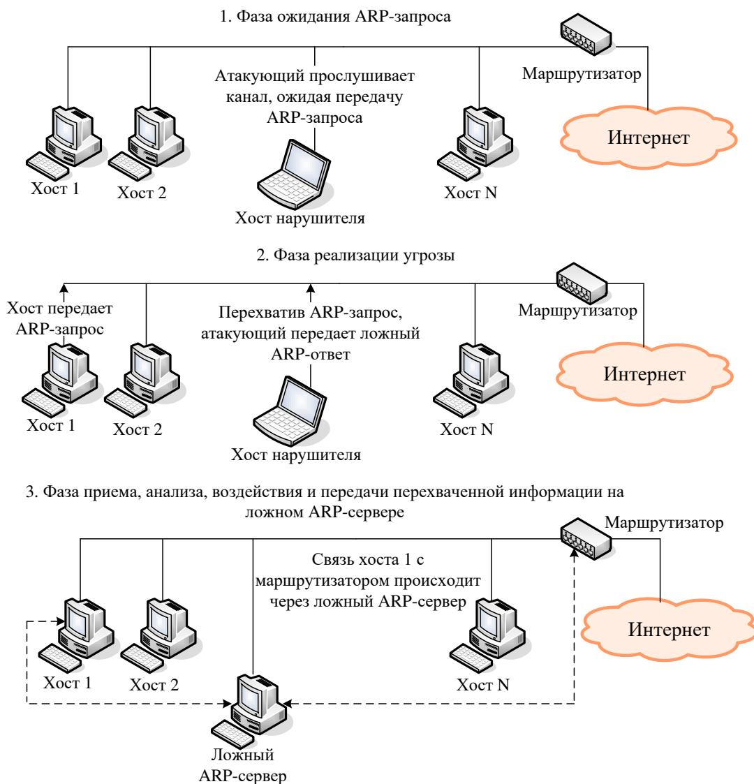
Рисунок 10. Схема реализации угрозы «Внедрение ложного ARP-сервера»
