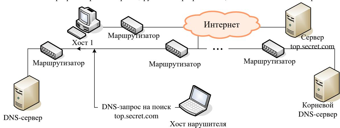
2. DNS-сервер передает DNS-запрос на корневой DNS-сервер и немедленно получает ложный DNS-ответ от атакующего
