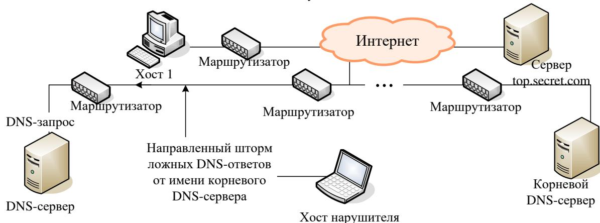
3. Хост нарушителя изменяет кэш-таблицу DNS-сервера и обеспечивает прохождение трафика через ложный Сервер top.secret.com
