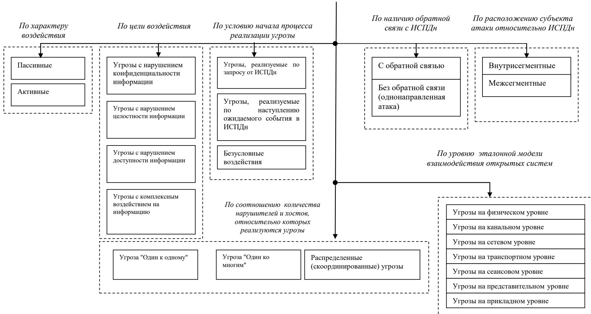
Рисунок 5. Классификационная схема угроз с использованием протоколов межсетевого взаимодействия
