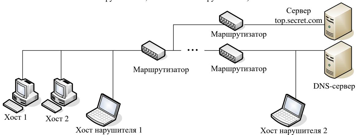
2. Фаза передачи атакующим ложного DNS-ответа (атакующий находится либо на хосте нарушителя 1, либо на хосте нарушителя 2)
