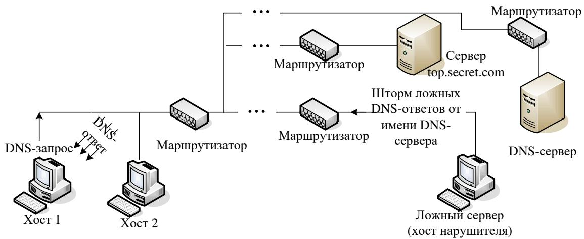
3. Фаза приема, анализа, воздействия и передачи перехваченной информации на ложном сервере
