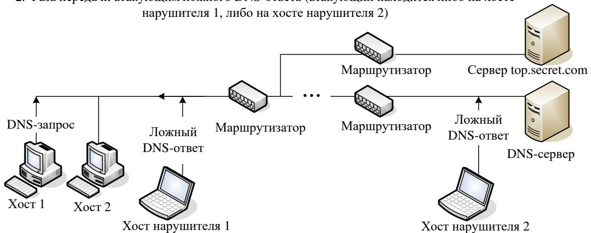
3. Фаза приема, анализа, воздействия и передачи перехваченной информации на ложном сервере
