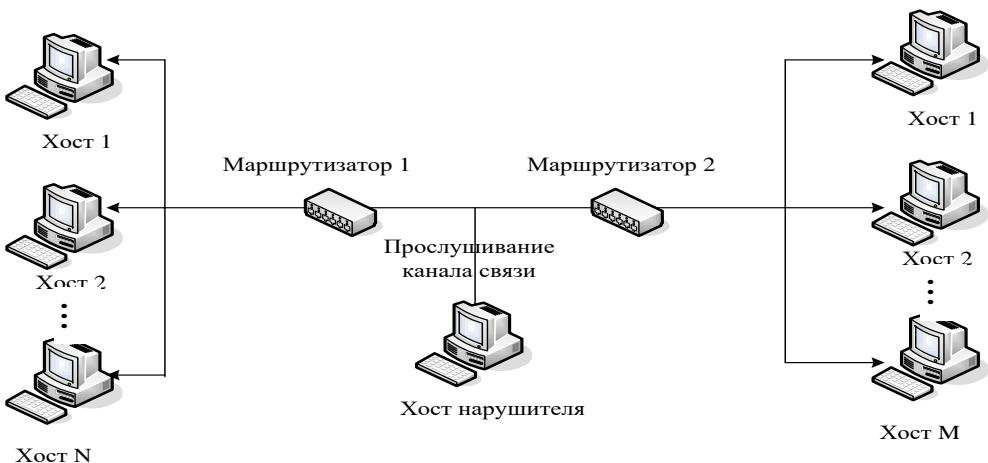
Рисунок 6. Схема реализации угрозы «Анализ сетевого трафика»
